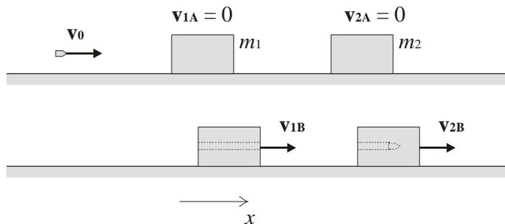
(a) Considerando-se que não há interferência de forças externas sobre o movimento do sistema, há conservação do momento linear. Seja  $m_b$  e  $v_{0b}$  a massa e a velocidade inicial da bala,  $m_1$  a massa do bloco de 1,22 kg e  $m_2$  a massa do bloco de 1,78 kg. Colisão entre a bala e  $m_2$ :
