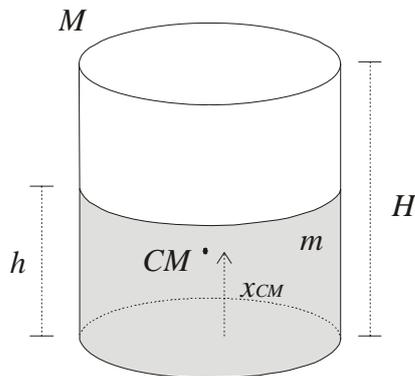
Para resolver este problema temos de construir uma função matemática para a posição do centro de massa ( $x_{CM}$ ) em função do nível de gasolina no tanque ( $h$ ). Em seguida devemos encontrar o valor de  $h$  que minimiza  $x_{CM}$  ( $dx_{CM}/dh = 0$ ). A posição do centro de massa é dada por:
