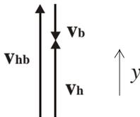
Observa-se a seguinte relação de velocidades na presente situação, em que  $v_b$  é a velocidade do balão,  $v_h$  é a velocidade do homem e  $v_{hb}$  é a velocidade do homem em relação ao balão ( que o problema chamou simplesmente de  $v$ ), sendo todas as velocidades verticais:
